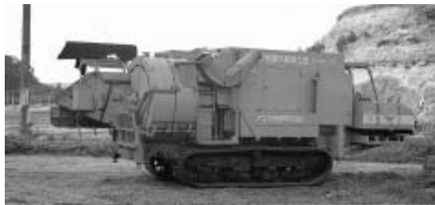
JMERY：クローラ自走式300ps 最大処理直径50cm
