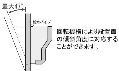
回転機構により設置面の傾斜角度に対応することができます。
