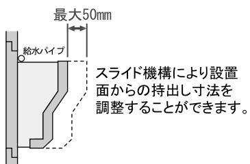
スライド機構により設置面からの持出し寸法を調整することができます。
