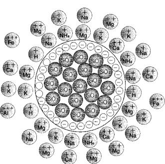
図1 コロイド粒子のモデル図と働き
