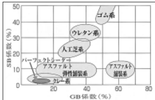
SB反発係数は弾性反発性を、GB反発係数は衝撃吸収性を表します。「パーフェクトシーダー」は、柔らかなクレイ系舗装並みの衝撃吸収があることが分かります。
