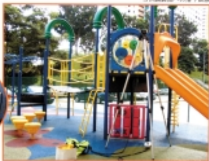
ゴム舗装部への落下試験
