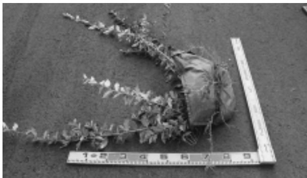
施工1年後、本体裏面より根系が旺盛に進出（アキグミ）
