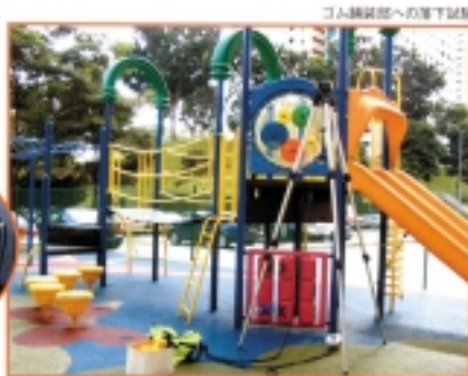
ゴム舗装部への落下試験
